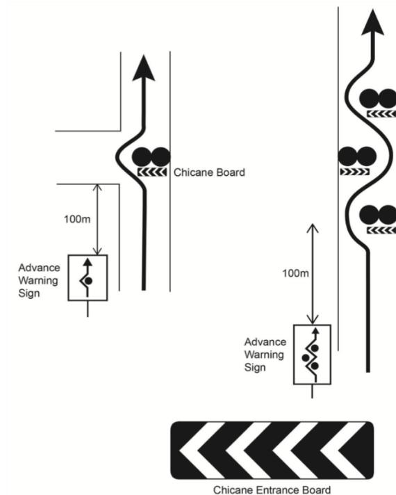
La signalisation et les marques indiquant la position exacte des éléments de la chicane doivent être mises en place avant le début des reconnaissances.
