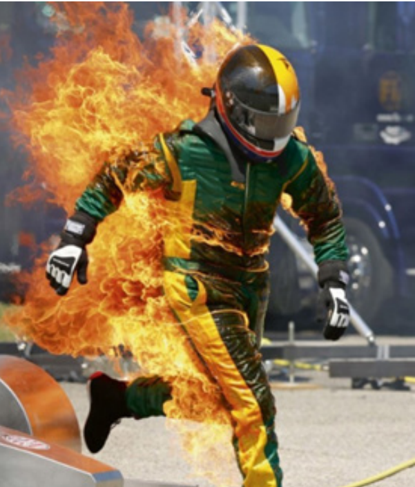
Figure 1 - Cascadeur en feu équipé de vêtements, d'un casque et d'un dispositif RFT approuvés par la FIA
