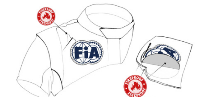
Figure 6 – Fixation des badges (fil et support ignifugés)
